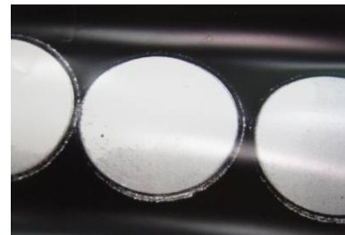
Bild 1: Abtrag mit einer runden 600 µm Faser = 0,283 mm 2
